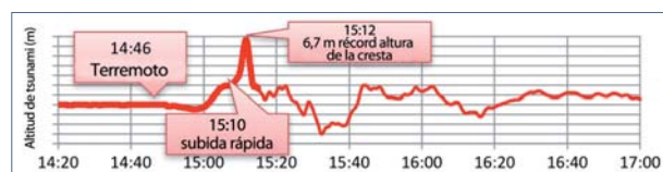
Boya georreferencial a 204 m de profundidad situada en el puerto de Kamaishi (Japón) que registró la primera cresta de la ola que superaba los 6 m en el terremoto tsunamigénico de Tohoku-oki de 2011. Perfil obtenido de la Oficina de Puertos y Aeropuertos, Ministerio de Tierras, Infraestructura, Transporte y Turismo de Japón y procesado por el Instituto de Investigación de Puertos y Aeropuertos (PARI) de Japón.
